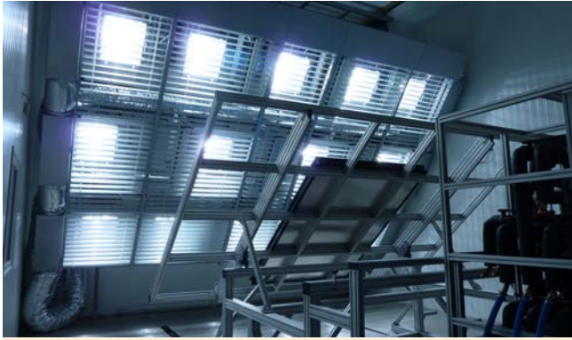
Dynamischer Sonnensimulator am Forschungs- und Testzentrum für Solaranlagen (TZS) des Instituts für Thermodynamik und Wärmetechnik (ITW) der Universität Stuttgart
