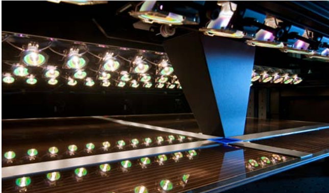
Innerhalb der Modulfläche frei wählbarer, 5 mal 5 Zentimeter großer Messbereich
